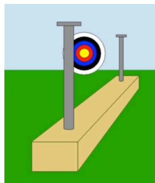
つきりと見えない。こんなものを作る必要はない。代わりに、片方の腕をまっすぐに伸ばして一本の指を鉛直に立ててみる。それでもなるまでに標的の中心が消えるポイントがあるはずだ。このときに釘の基準軸が正確に標的に一致したのだ。
